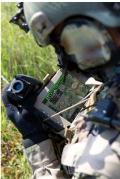
S'ajoutant à l'affichage, dans le fond cartographique, du résultat d'une mesure effectuée depuis un télémètre<sup>5</sup> connecté à la **DELTA SUITE**, ce module permet d'agir sur certains paramètres du capteur (changement de voie, lancement d'une télémétrie) et d'afficher dynamiquement le secteur d'observation ainsi que le déport vidéo.
